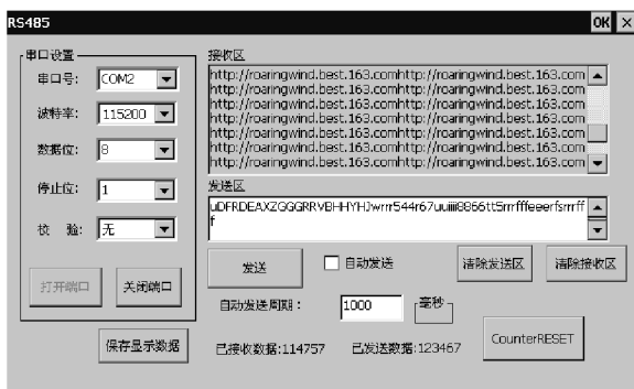
图 7 运行在 WINCE 上的 RS485 测试工具界面
