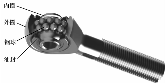
图 1 机体杆端摆动轴承组成图
