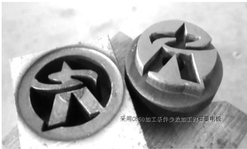
图 7 反拷制作石墨电极
