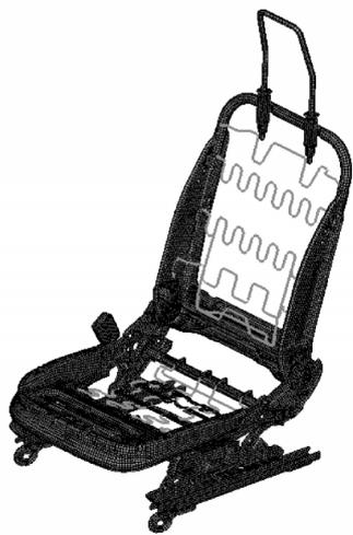
图6 座椅骨架模型
