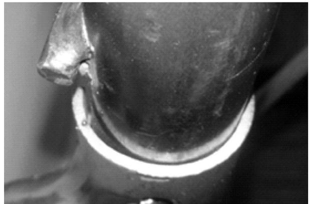
图4 座椅背管与背搭接板连接处变形情况
