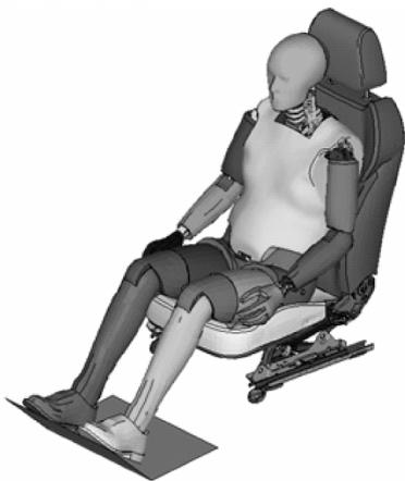
图5 座椅鞭打模型
